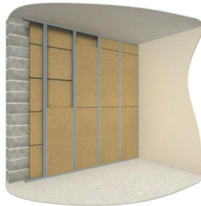
**Figure 4.2 - Insertion de la 2<sup>e</sup> couche ISONAT FLEX (40 mm) entre montants M48**
