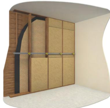
**Figure 5.2 - Installation de la fourrure intermédiaire et des appuis Optima<sub>2</sub> clipsés sur fourrure**
