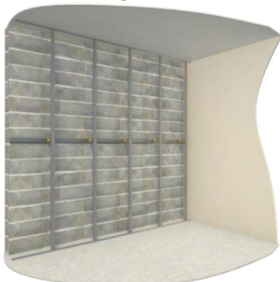
**Figure 3.1 - Pose de l'ossature métallique Optima<sub>2</sub> (Lisses, Fourrures, Rallonges et appuis Optima<sub>2</sub>)**
