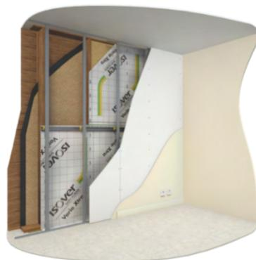
**Figure 5.3 bis - Pose de la fourrure intermédiaire et des appuis Optima<sub>2</sub> clipsés. Pose des fourrures métalliques verticales puis celle du parement de finition**
