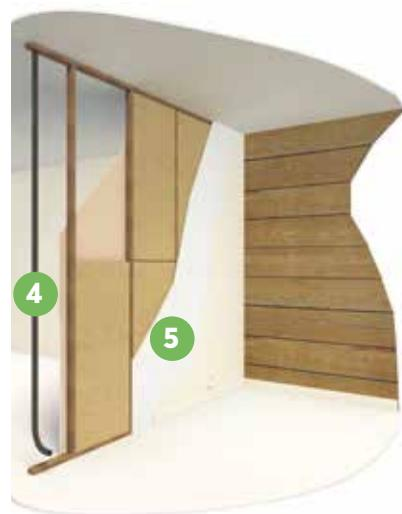
**4** Passage des gaines électriques si nécessaire
