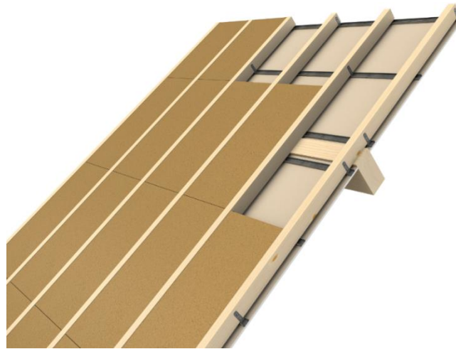
Figure 8 : Mise en œuvre de l'isolation entre chevrons
