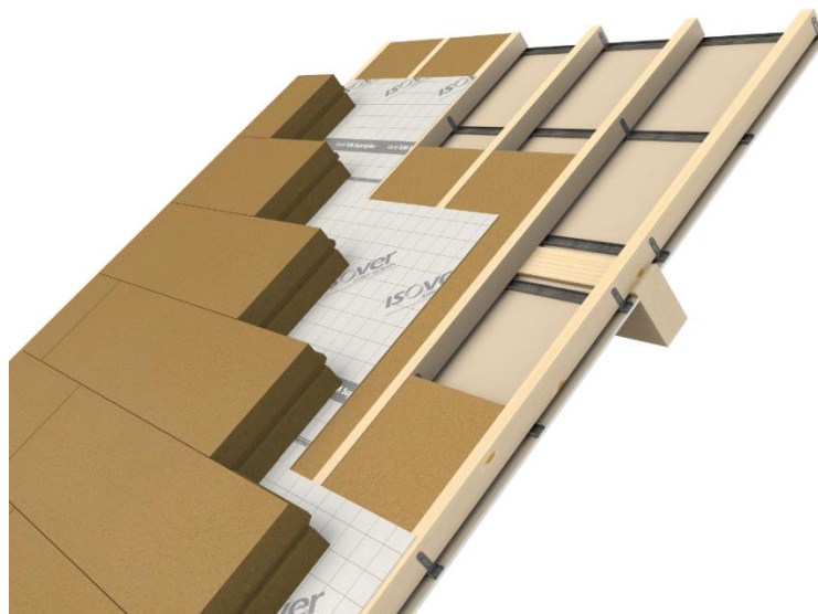
Figure 14 : Mise en œuvre de panneaux Multisol 140 sur chevrons
